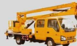
(Log Grab) 高空作业车
